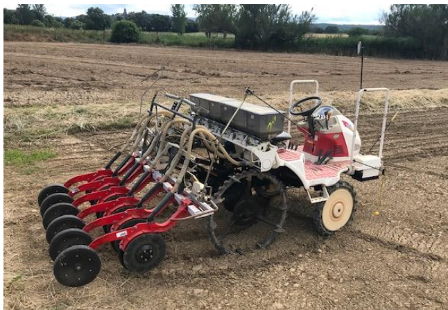
Figura 1. Eina desenvolupada per al desherbatge mecànic en el cultiu d'arròs amb reg per inundació. (Foto: Enginyeria i gestió del reg, UdG).
