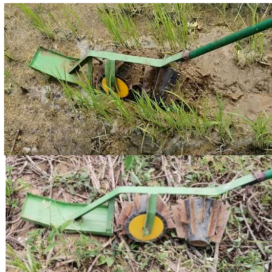
Figura 2. Eina desenvolupada per al desherbatge mecànic en el cultiu d'arròs amb reg per inundació. (Foto: Enginyeria i gestió del reg, UdG).
