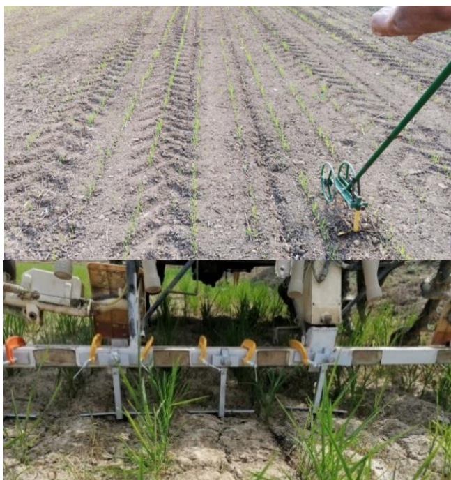
Figura 3. Eina desenvolupada per al desherbatge mecànic en el cultiu d'arròs amb reg per degoteig enterrat. (Foto: Enginyeria i gestió del reg, UdG).
