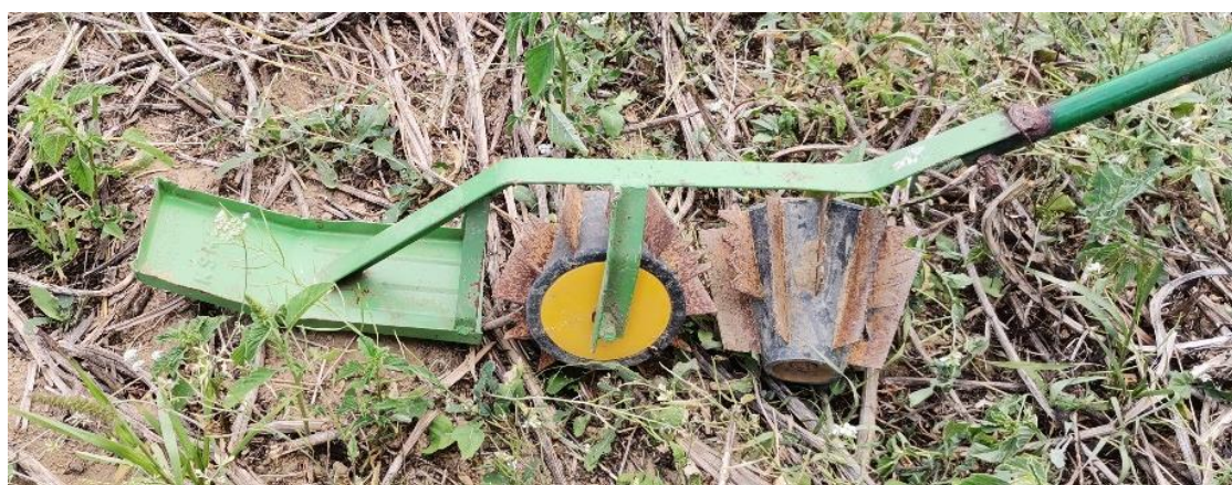
Figura 9.- Eina expressament desenvolupada per al desherbatge mecànic en moll a la parcel·la d'assaig A
