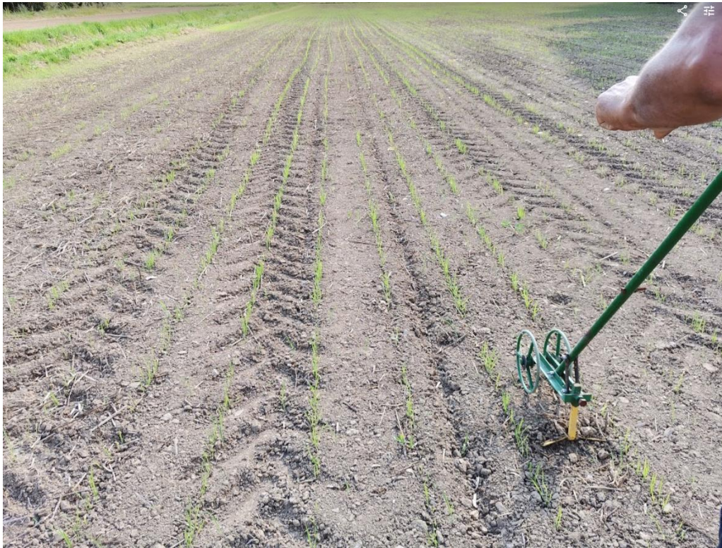
Figura 18.- Prova amb accionament manual de la rella dissenyada per al desherbatge mecànic en arròs amb degoteig enterrat.
