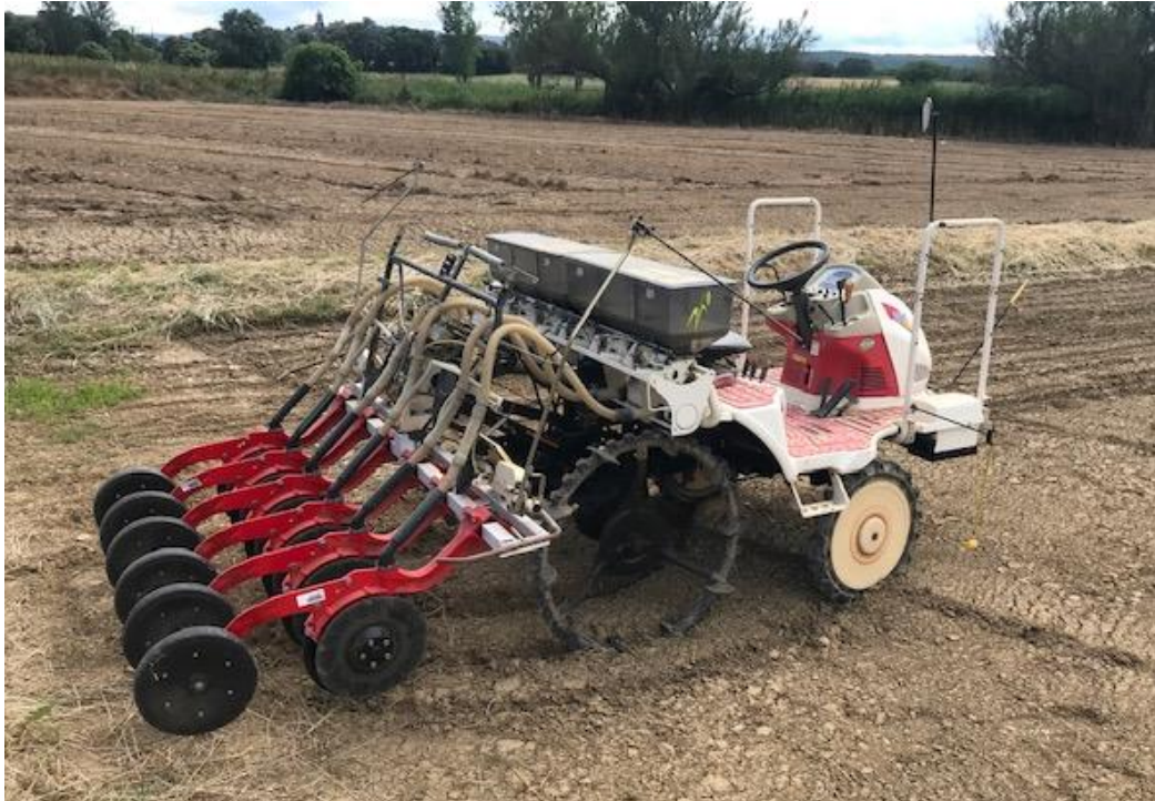
Figura 4.- Sembradora utilitzada per a la sembra de les parcel·les d'assaig.
