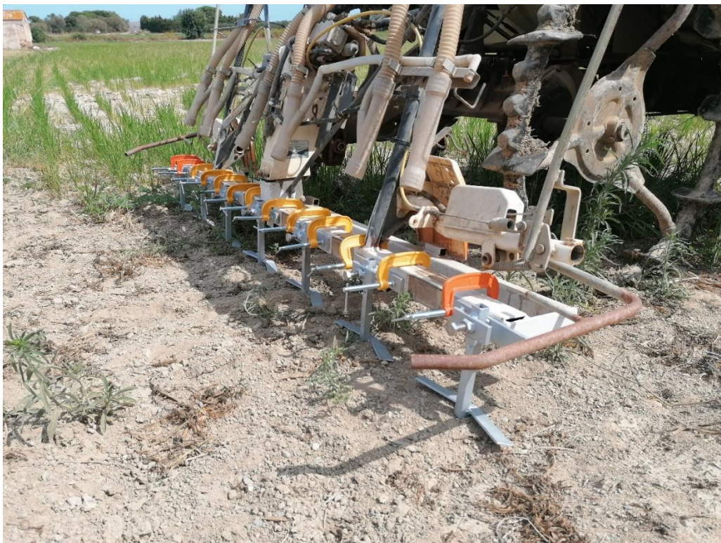
Figura 19.- Vista lateral de l'eina per a desherbar mecànicament l'arròs cultivat amb reg per degoteig enterrat.
