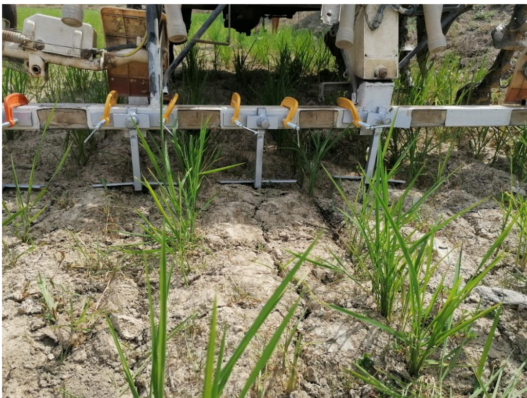
Figura 21.- Detall del posicionament en el cultiu de l'eina per a desherbar mecànicament l'arròs cultivat amb reg per degoteig enterrat.
