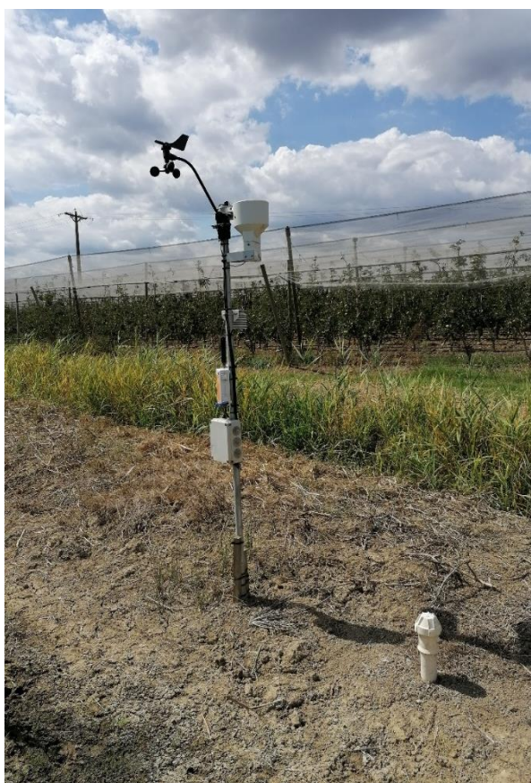
Figura 6.- Estació meteorològica instal·lada a la parcel·la d'assaig B
