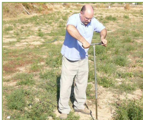
Figura 1. Presa d'una mostra de sòl mitjançant una barrina (DAAM, 2013).
