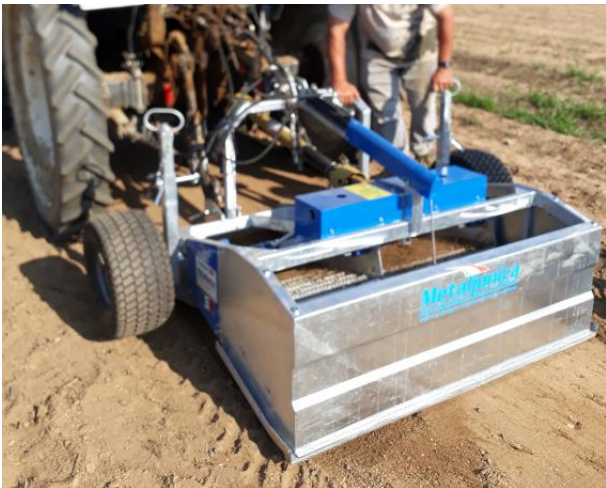
Foto 9: Detall de la màquina per a netejar platges adquirida per la Cooperativa de la Conca de la Tordera utilitzada per a extraure tubercles de jonça en camps d'horta del Maresme
